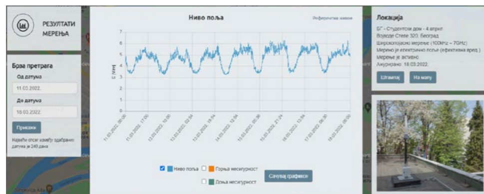
Слика 11. Графички приказ нивоа електромагнетског поља за сензор постављен на објекту Студентски дом „4. април“, у Београду
